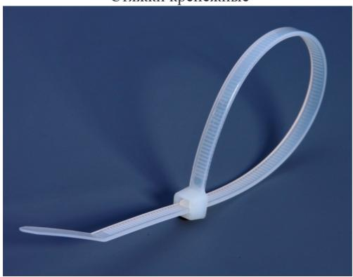
Предназначена для крепежа и соединения в жгут кабелей и проводов.Изготавливается из нейлона, не содержит галогенов, самозатухающая.Температурный диапазон: от -40°C до +85°C.Замковый механизм одностороннего хода.Неразъемный.
